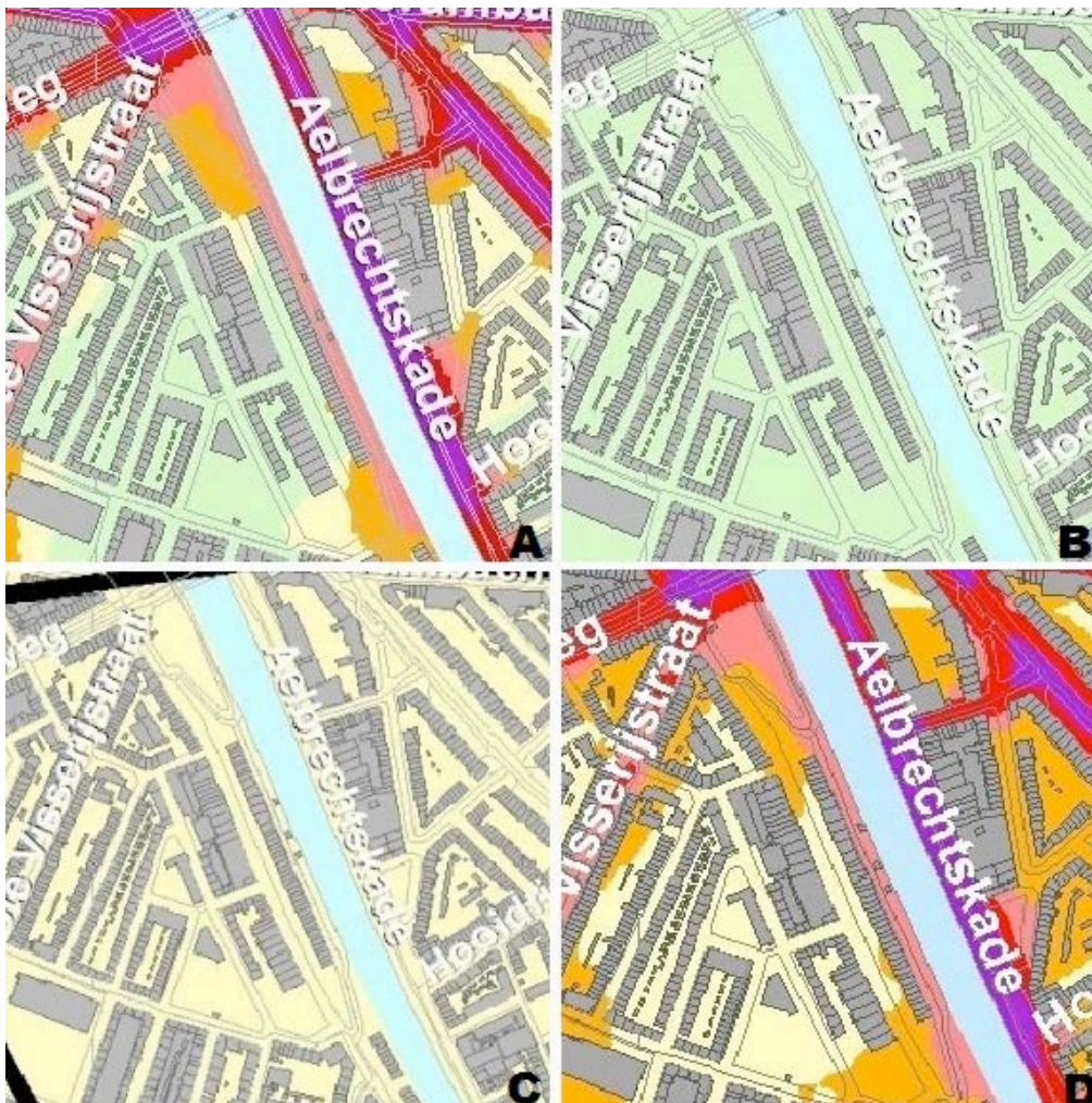
Afbeelding 5: Uitsnede geluidkaart Rotterdam, wegverkeerslawaai (a), railverkeerslawaai (b) industriellawaai (c) en gecumuleerd (d).
